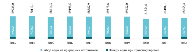
Рисунок 4.38 – Динамика основных показателей забора воды и потерь при транспортировке в целом по Российской Федерации, 2013-2022 гг., млн м 3
